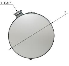
TANK DIAMETER Ø 380 Ø 460 Ø 570 Ø 635 Ø 660 Ø 710
